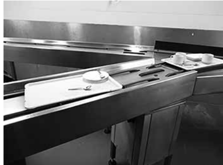
(ベルトでトレーを流す)
