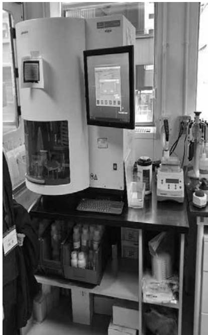
右側：ハッケンサックUMHと同種のCOVID-19PCR検査装置FilmArray TORCH
