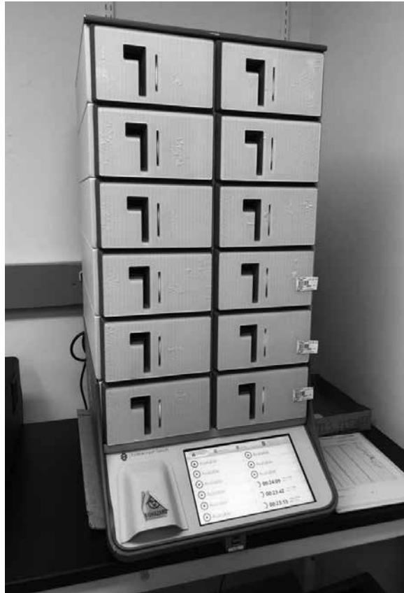
右側：ハッケンサックUMHと同種のCOVID-19PCR検査装置FilmArray TORCH
